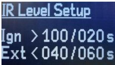
Это подменю позволяет регулировать условия, при которых фотодатчик определяет наличие стабильного или нестабильного пламени и сигнализирует горелке перейти в рабочий режим или гаситься.
