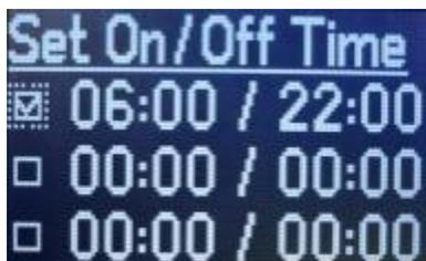
Пример: На рисунке показана первая галочка, она должна быть установлена, и рядом с ним время запуска горелки в 06:00 и отключение в 22:00.
