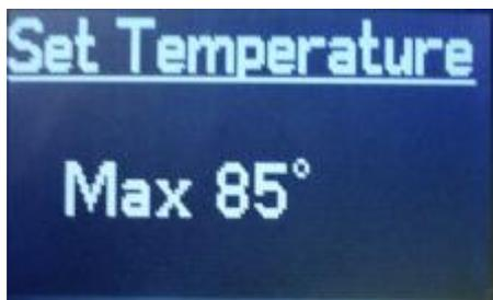
Это меню позволяет выбрать максимальную температуру котла. Другими словами, максимальная температура нагрева котла, на котором горелка была установлена. Максимальное значение этого параметра составляет 85 °С.
