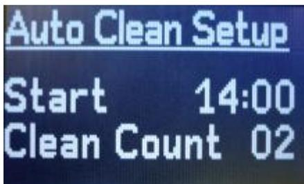
Используйте это меню для настройки автоматической очистки горелки с помощью очистки двигателя. Вы можете установить время первой чистки (Start) и количество чисток в течение 24-часового периода (Clean Count).
