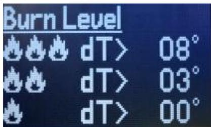
Горелка имеет три основных уровня горения (три основных режима работы мощности). Используйте это меню для установки разницы температур, при котором горелка будет смещаться от более высокого режима мощности к снижению (шаг модуляции). Пример : Мы установили максимальную температуру 85 ° С. По достижении 77 ° С,
