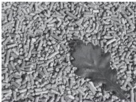
Все гранулы производятся из общей биомассы низкорослых растений и деревьев. Наиболее распространенные бытовые гранулы изготавливаются из опилок и измельченной древесины, стружки, которые являются отходами древесины, используемой в производстве журналов, мебели и других изделий. Древесина является самым богатым сырьем, которое не имеет никакого влияния на издержки
