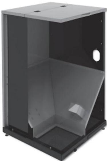
Емкость бункера определяется использованием в качестве базы расчета ежедневного или еженедельного расхода топливной горелки. Топливный бункер – используемый объем 500 литров позволяет заряжать 280-300 кг гранул диаметром 6 мм раз в неделю (для горелки мощностью до 40 кВт).
