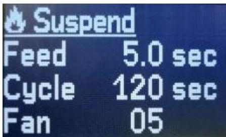
Это подменю позволяет настроить параметры спящего режима работы горелки. Вы можете изменить количество гранул (Feed), временной интервал, на котором эти гранулы подаются (цикл) и выхода вентилятора в процентах (FAN). Пример: периодичность установлена на 20 секунд, гранулы подаются в течение 5 секунд в горелку, и выключаются в течение
