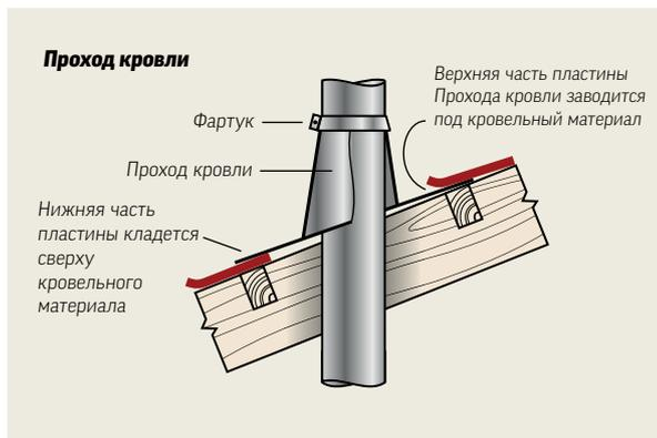
При монтаже следует помнить, что минимальное расстояние от дымохода до горючих конструкций, обработанных огнезащитным составом, должно быть не менее 380 мм (согласно СНиП 41.01.2003), (Приложение К).
