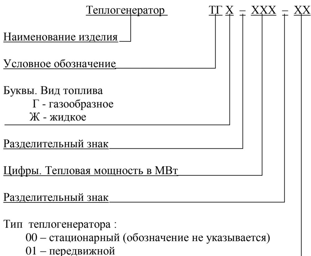
Примеры обозначения теплогенератора при заказе;
