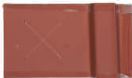
Рисунок 15. Образец после испытания в камере влажности 1000 часов.
