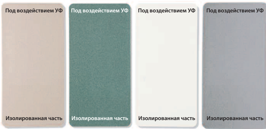
Рисунок 20. Изменение цвета образцов Colorcoat Prisma® после прохождения теста QUVA на протяжении 6000 часов (по EN 13523-10).
