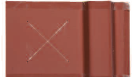
Рисунок 16. Образец после испытания погружением в воду 1000 часов.
