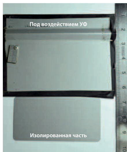
Рисунок 21. Colorcoat Prisma® Silver Metallic (RAL 9006) после 5 лет испытаний
