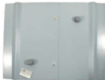
Рисунок 12. Образец Colorcoat Prisma® после двухлетних испытаний в среде с агрессивностью категории C5.*
