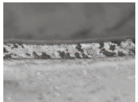
Рисунок 7. Микроструктура Galvalloy® - после коррозии
