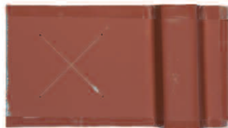
Рисунок 16. Образец после испытания погружением в воду 1000 часов.
