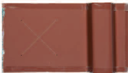
Рисунок 15. Образец после испытания в камере влажности 1000 часов.
