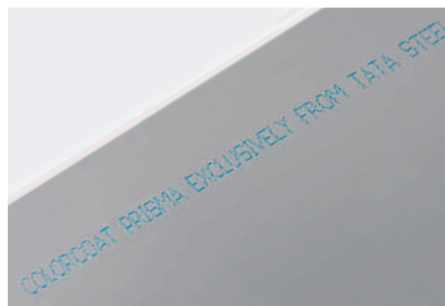
Рисунок 8. Маркировка с обратной стороны стали с покрытием
