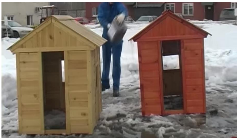
Облив двух образцов бензином для испытания антипирена (справа защищенный образец)
