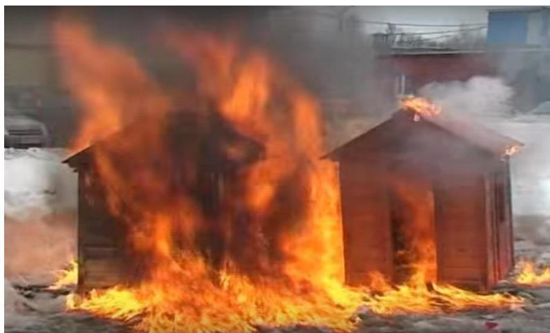
Горение образцов для испытания антипирена (справа защищенный образец)
