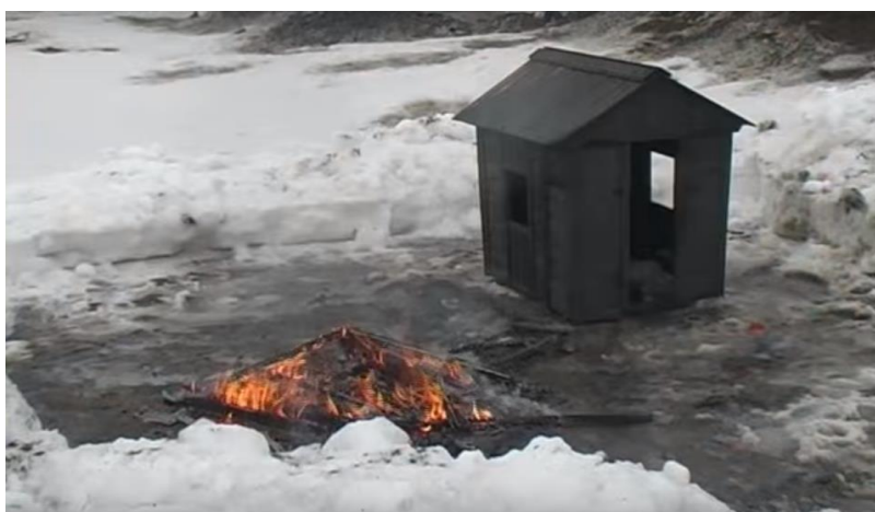
Результат испытаний 17 (защищенный образец обгорел не более чем на 9% от общего объема материала)
