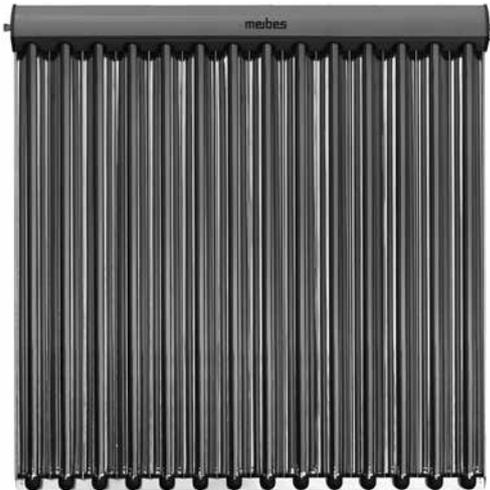
**Продукт:** вакуумный коллектор **MVK 001** предназначен для преобразования солнечного излучения в тепловую энергию. Устанавливаются только вертикально под углом горизонту от 15° до 75°.
